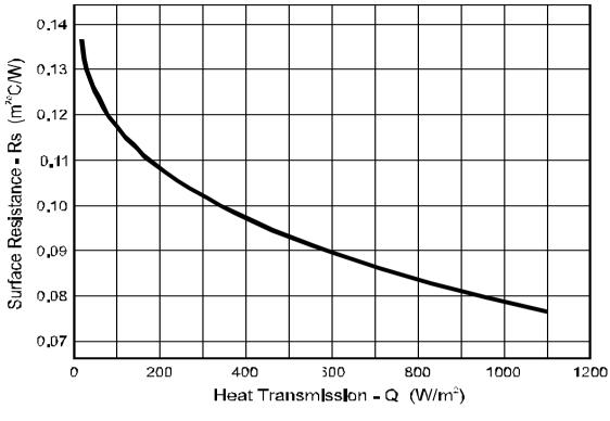
Figure 2.7 HEAT TRANSMISSION vs SURFACE RESISTANCE
